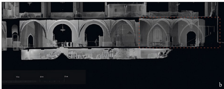
Il. 9. TORUŃ, kościół p.w. Wniebowzięcia NMP, domniemana kaplica Grobu Świętego: a) widok z dawnego krużganka w stronę zachodnią, fot. J. Raczkowski, b) przekrój podłużny z zaznaczeniem zasięgu kaplicy, cięcie z inwentaryzacji 3D w programie PointCab
