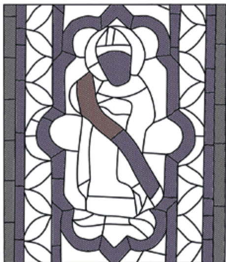
Il. 9. TORUŃ, kościół dominikański pw. św. Mikołaja, kwatera witrażowa z przedstawieniem Amosa – mapa autentyczności. Szrafowanie: fioletowe – szkła pochodzące z XV-wiecznej naprawy, czerwone – szkła pochodzące z XIX-wiecznej konserwacji, szare – szkła pochodzące z ostatniej konserwacji z lat 1955–1959. Oprac. i rys. A. Graczyk
