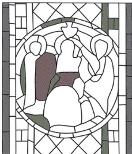
Il. 13. Toruń, kościół dominikański pw. św. Mikołaja, kwaterna witrażowa z przedstawieniem Chrztu Chrystusa – mapa autentyczności. Szrafowanie: fioletowe – szkła pochodzące z XV-wiecznej naprawy, czerwone – szkła pochodzące z XIX-wiecznej konserwacji, szare – szkła pochodzące z ostatniej konserwacji z lat 1955–1959. Oprac. i rys. A. Graczyk
