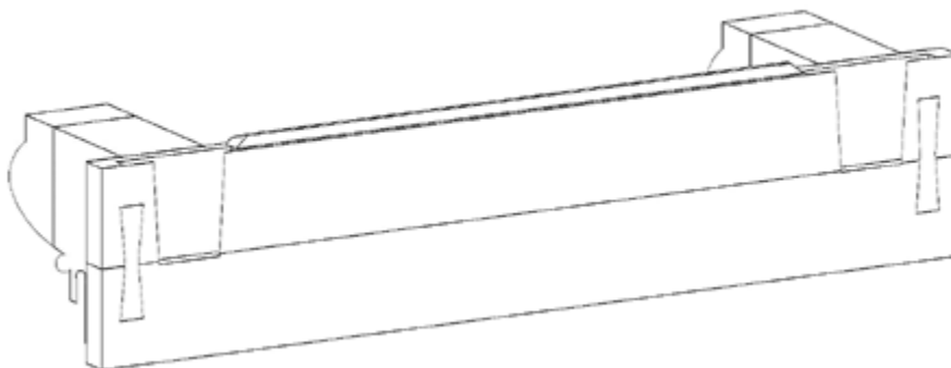
II. 9. TORUŃ, kościół pw. św. Jana Chrzciciela i św. Jana Ewangelisty, retabulum ołtarza pw. Zaśnięcia NMP. Strefa cokołowa retabulum zbudowana w konstrukcji wieloskrzyniowej ze skrzyniami o korpusach pozornych, rysunek w aksonometrii rozłożonej. Oprac. W. Kofel
