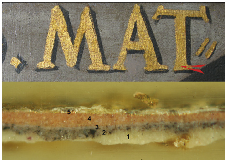
II. 3. PIENIĄŻKOWO, kościół pw. św. Jana Chrzciciela, obraz ze św. Mateuszem. Przekrój próbki z warstwy złoceni z litery „T”, 1 – biała zaprawa: kreda, biel ołowiowa; 2 – szara warstwa: czerń roślinna, biel ołowiowa; 3 – jasnoszara warstwa: czerń roślinna, biel ołowiowa; 4 – czerwona warstwa: czerwień żelazowa, cynober, biel ołowiowa; 5 – złocenia. Fot. B. Szmelter-Fausek
