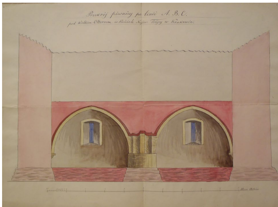
Il. 10. Przekrój piwnicy po linii A–B–C pod wielkim ołtarzem w kościele Najświętszej Trójcy w Krakowie, przed 1876 r. Muzeum Narodowe w Krakowie, MNK III-PL.-194. Fot. M. Szyma
