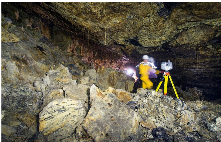
Il. 3. Badanie komory w kopalni Królowa Luiza w Zabrzu. Miejsce pracy skanera (komora znajduje się ok. 80 m pod powierzchnią ziemi). Fot. Ł. Zawada
